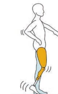
遊脚相では、通常の歩行パターンと異なる動作を検知すると、立脚相よりも大きな油圧抵抗が働き、突然の荷重でもしっかりと体重を支えます。
