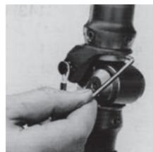
3mm六角レンチを用いて膝後方のネジを回すことによって、定摩擦が変わります。
