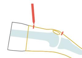
10.膝屈曲角度を10°で保ち、採型ポンプの電源を入れます。補足：断端長が10cm未満の場合は、膝屈曲角度を20°にすると、良好な結果が得られます。
