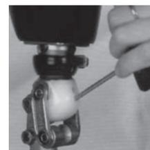
多軸の位置関係を変更し、瞬間回転中心を変えることによって安定性を調整できます。
