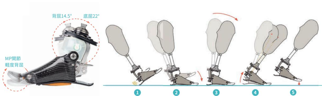
多軸構造と大きな関節可動域の動きが、路面やスピードに応じて自動でコントロールされます。
