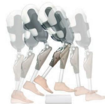
ユーザーが指定の動作(股関節を一瞬伸展させてから、屈曲させる)をすることで、膝がフリーに大きく屈曲する。この状態で義足を前に振り出すことで、障害物や段差を乗り越えることができる。義足が接地する際には、確実な油圧抵抗が発揮されてロックされるため、Geniumに体重をあずけることができる。
