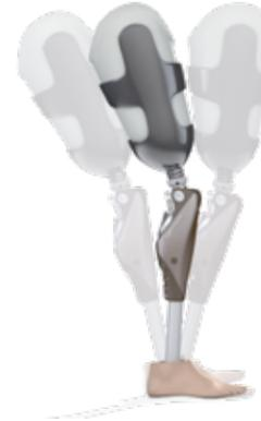
センサーの検知により、ユーザーが立位を維持しようとしているのか、歩き出そうとしているのか、Geniumが判断する。立位を維持する場面では、膝が曲がらないように自動的にロックがかかるため、Geniumに完全に体重をあずけることができる。重心が少しでも前に移動すればロックは解除されるため、スムーズに動き出すこともできる。平地だけでなく、斜面や不整路面においても、安心して立位を保持することができる。この機能により、断端をリラックスさせ、健側の負担も軽減する。
