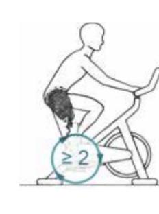
屋内に固定されたアップライトバイクを使用するための機能です。ペダルを2周漕ぐか、またはアプリで起動すると、抵抗値が小さくなり軽く漕げるようになります。動作での起動：サドルに座り2回転以上漕ぎます。コックピットアプリでの起動：サドルに座りアプリで切替えます。
