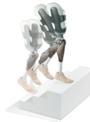
階段をスムーズに降りることは、C-Legでも可能だった。しかし、Geniumでは、上ることも可能となった。障害物の乗り越えと同じ指定の動作をすることで、Geniumを曲げ、上の段に足をかける。接地した状態ではGeniumはロックされるので、このまま断端筋力を使い蹴り上げることで、昇段が可能となる。
