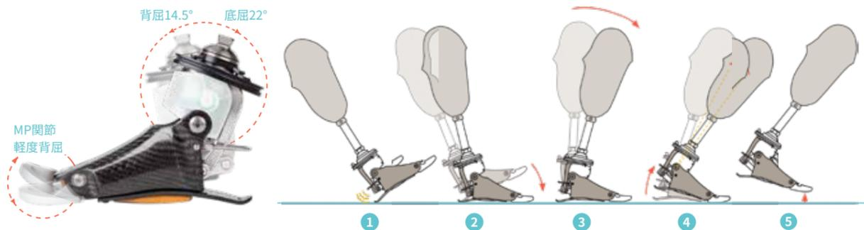
多軸構造と大きな関節可動域の動きが、路面やスピードに応じて自動でコントロールされます。
