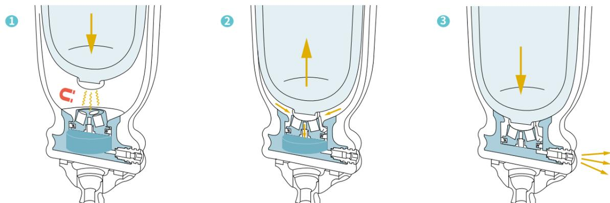
ソケットに断端を挿入すると、ライナーと DVS 本体がマグネットで接続されます。義足に荷重されるとソケット内の空気が排出されます。
