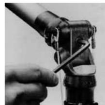
膝を曲げると6mmの調整ネジがあります。このネジの締め込みによって荷重ブレーキが調整できます。
