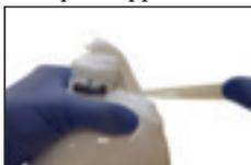
Collez le ruban adhésif en polyéthylène 627B40 sur les endroits à ouvrir après la stratification en réduisant les résidus de résine présents à ces endroits à l'aide du ruban adhésif pré-tendu. Il est possible de tordre le ruban adhésif sous pré-tension comme une corde afin de réduire les résidus de résine même sur les zones difficiles d'accès.
