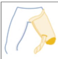
4. Tirez délicatement sur la boucle de l'Easy-Proth® pour le faire sortir de l'ouverture de soupape de l'emboîture de la prothèse.
