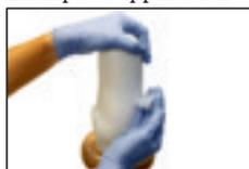
Prélevez une quantité de graisse de silicone 633F23 suffisante pour le modèle et appliquez-la uniformément en fine couche sur le modèle.
