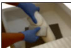
À l'aide du papier émeri Soft Pad imbibé, traitez le modèle en plâtre en effectuant des mouvements circulaires avec la surface du grain sans trop appuyer. Ne rincez pas les résidus d'émeri sous l'eau courante. Le papier émeri Soft Pad peut être plié au milieu afin de permettre un traitement des petits rayons sans endommager le bord.
