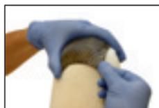
Placez la pièce découpée en fibres de carbone sur les zones à renforcer de l'armature et effectuez une pré-tension de la pièce découpée dans le sens des fibres.
