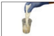
Retirez du flacon ou du verre doseur le jersey tubulaire imprégné de liquide de séparation pour plâtre et enfitez-le directement sur le modèle.
