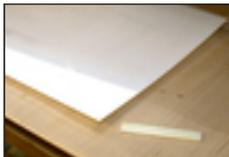
Recouvrez le modèle en plâtre de jerseys tubulaires, tels que le bas en nylon sur rouleau 81A1 ou le jersey tubulaire Perlon 623T3, avant de procéder au thermoformage. Découpez le pré-imprégné thermoplastique 617R11=PE/PP et le thermoplastique aux dimensions appropriées et déposez-les dans le four préchauffé jusqu'à ce qu'ils soient suffisamment chauds pour le thermoformage (par ex. transparents dans le cas du ThermoLyn PP-H).
