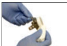
Nettoyez soigneusement les objets assemblés avant la stratification avec l'alcool isopropylique 634A58.
