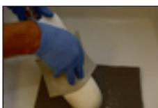
Imbibez à nouveau totalement le papier émeri Soft Pad et retirez le modèle en plâtre du côté mousse pour refermer les fines soufflures et piqûres à l'aide des résidus de plâtre.
