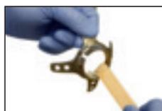
Enduisez les objets à isoler avant la stratification avec la graisse de silicone (par ex. filetage d'une vis, gabarit de stratification, adaptateur, articulations d'orthèse). Attention : n'isolez pas les zones qui doivent entrer en contact avec la résine de stratification.
