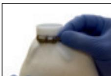
Isolez les zones appropriées des objets à stratifier à l'aide du ruban plastifié préformé (par ex. les têtes de vis, les spires dégagées, les surfaces antagonistes).
