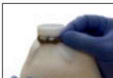
Isolez les zones appropriées des objets à stratifier à l'aide du ruban plastifié préformé (par ex. les têtes de vis, les spires dégagées, les surfaces antagonistes).
