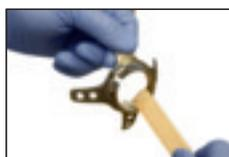
Enduisez les objets à isoler avant la stratification avec la graisse de silicone (par ex. filetage d'une vis, gabarit de stratification, adaptateur, articulations d'orthèse). Attention : n'isolez pas les zones qui doivent entrer en contact avec la résine de stratification.
