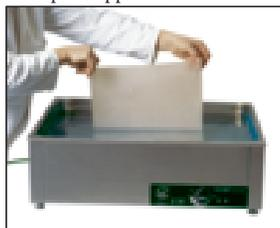
Posez la découpe de matière en ThermoLyn Pedilon dans l'eau du bac 759P1=220 chauffée à env. 60 °C. La matière devient transparente en atteignant la température de déformation. Retirez maintenant la découpe avec une spatule en bois et laissez l'eau s'égoutter.
