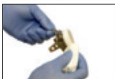
Участки, которые должны иметь контакт со смолой для ламинирования тщательно очистить с помощью изопропилового спирта 634A58.
