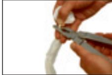
Чулок 99B25 натянуть, скрутить и зафиксировать плоскогубцами. Ножницами отрезать конец шва.
