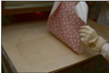
Полимерный материал нагревать до тех пор, пока он не достигнет достаточной температуры для процесса глубокой вытяжки (например, для ThermoLyn PP-H - пока он не станет прозрачным). Вырезанную согласно требуемым размерам термобумагу положить стороной с рисунком вниз на заготовку материала.
