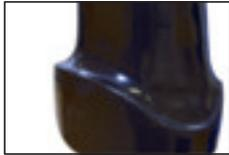
Произвести обычное армирование приемной гильзы, однако в желаемом месте сделать выемку, укрепить полиэфирным трикотажным материалом 616G26=150 и заламинировать.
