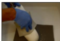
Шлифовальную бумагу Soft Pad вновь окунуть в воду до полного пропитывания и протереть гипсовую модель пенопластовой стороной для закрытия мелких пор возникшими остатками гипса.
