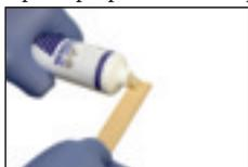
Нанести силиконовую смазку 633F11 объемом с горошину на деревянный шпатель 699Y3.
