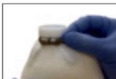
Соответствующие места предметов, подлежащих ламинированию, изолировать при помощи предварительно отформированной пластичной ленты (например, головки винтов, открытые винтовые нарезки, поверхности шарниров).
