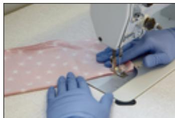
Ушить декоративный материал на 5 мм в пределах разметки. Дистальный шов должен принять коническую форму. Таким образом, шов будет заметен только на медиальной стороне. С помощью ножниц срезать декоративный материал вдоль внешней стороны шва на расстоянии не более 2 мм.
