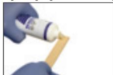
Нанести силиконовую смазку 633F11 объемом с горошину на деревянный шпатель 699У3.
