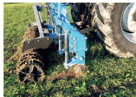
Tiefenlockerung der Weide mit Terractiv
