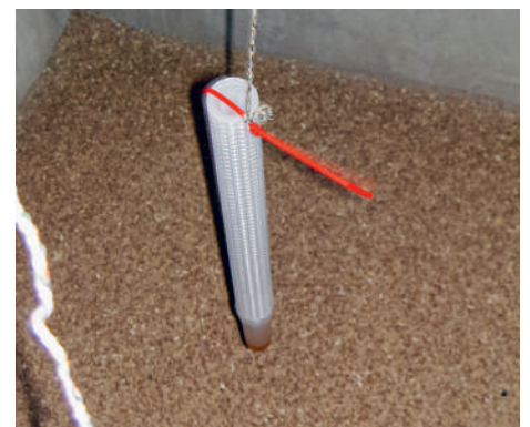
Einsatz Sondierfalle SILO
