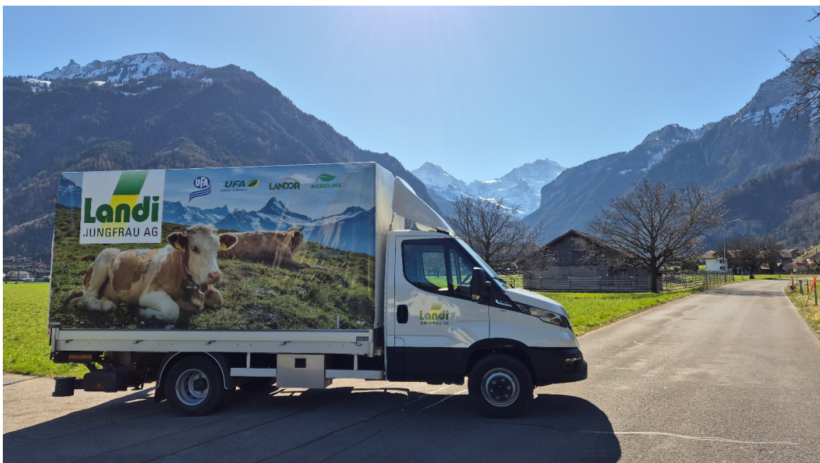
Iveco LANDI Jungfrau AG mit Hebebühne, Gesamtgewicht 7.5to, Nutzlast ca. 3.7to, Platz für 6-8 Paletten.
