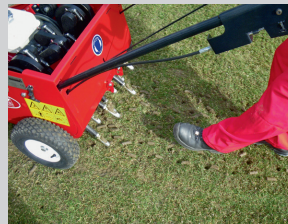
Im Rasen können Melocont und GranMet entweder mit dem Spaten (kleine Flächen) oder nach dem Aerifizieren eingestreut und eingearbeitet werden. Rasen tief mähen, vertikutieren, aerifizieren, Melocont/GranMet streuen und einbeseln. Doppelte Aufwendmenge.
