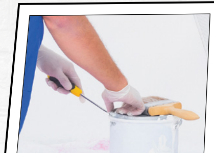
OUVRIR UN POT DE PEINTURE AVEC UN TOURNEVIS, LEVIER DU PREMIER GENRE
