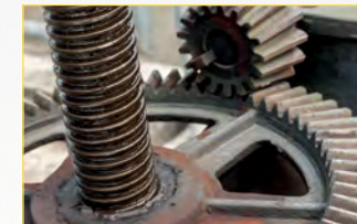
les engrenages coniques d'un barrage d'eau
