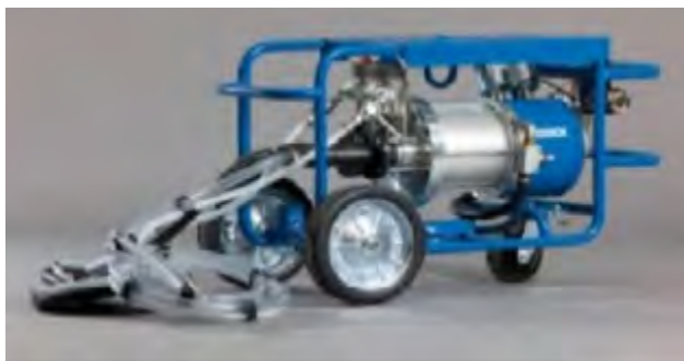
przykład pompy do iniekcji dwuskładnikowych
