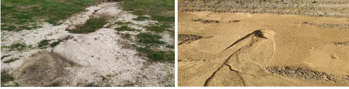
Resim 3.27. Hatay-Paşaköy, Hatay İskenderun İle Adıyaman-Gölbaşı ve Adıyaman Türkoğlu İlçelerinde Deprem Sırasında Meydana Gelen Sıvılaşmanın Görüntüleri
