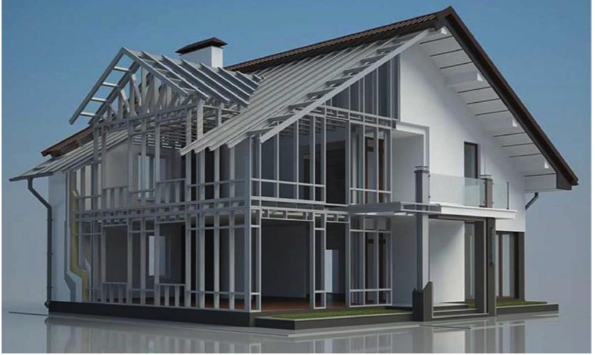
Şekil 3.42. Deprem Dirençli İki Katlı Hafif Çelik Konstrüksiyon Ev Projesi Kaynak: SerVilla Çelik Ev, Mimar Yağmahan İnşaat Ltd. Şti.
