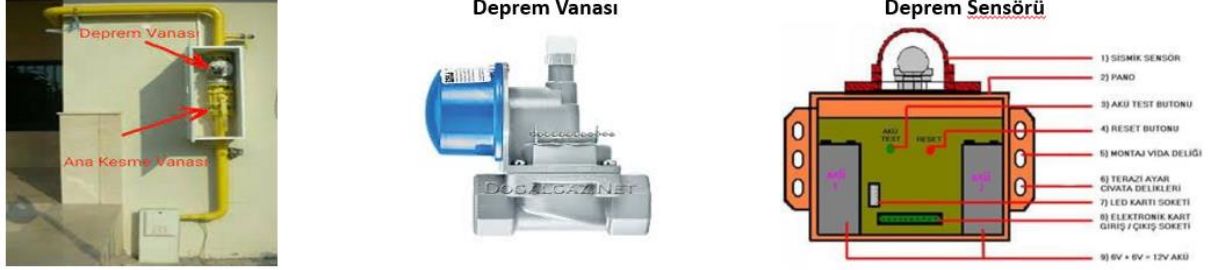
Resim 1.22. Doğal Gaz Şebekelerinde Gas-Stop (Check Valf) Uygulaması
