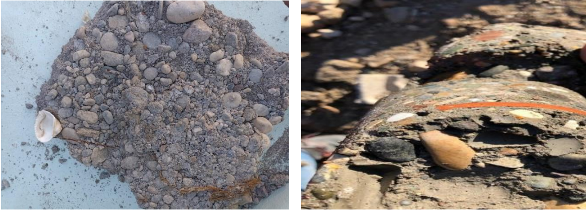
Resim 3.21. Dozajı Düşük Bir Döşeme Betonu
