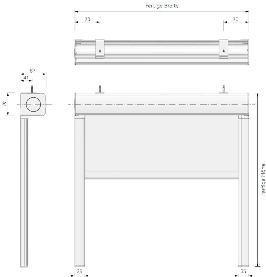
Seitliche Führungsschienen 35 mm
