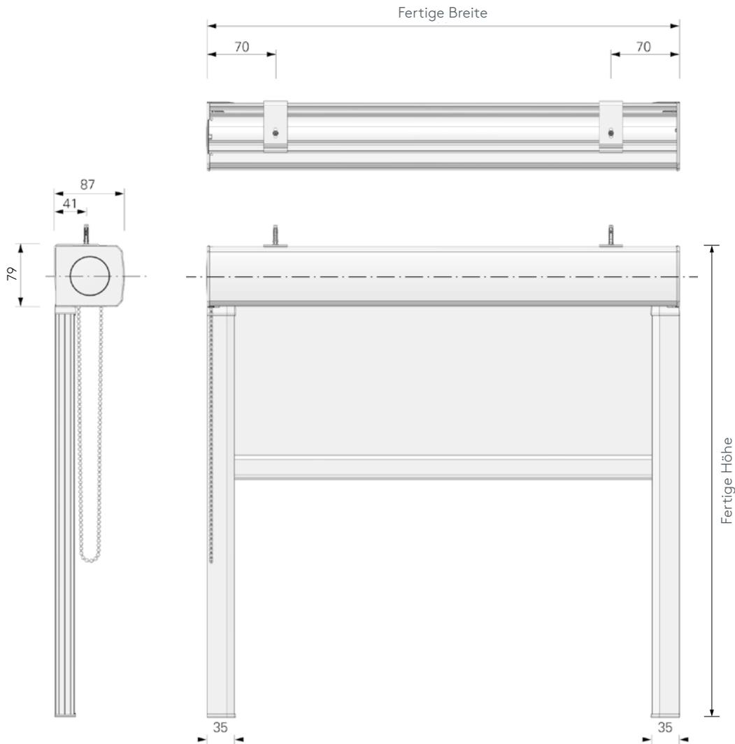
Seitliche Führungsschienen 35 mm
