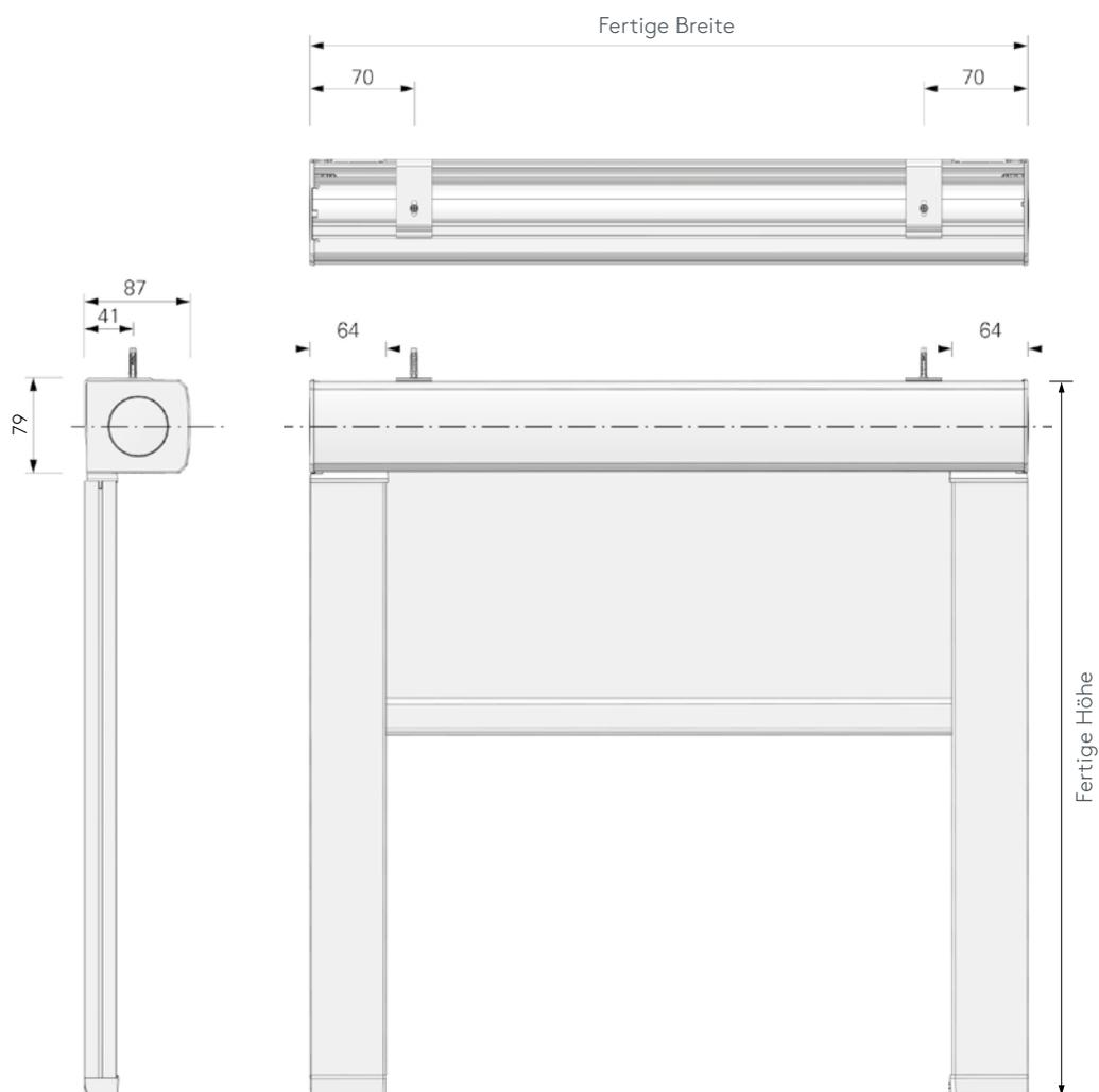
Seitliche Führungsschienen 64 mm
