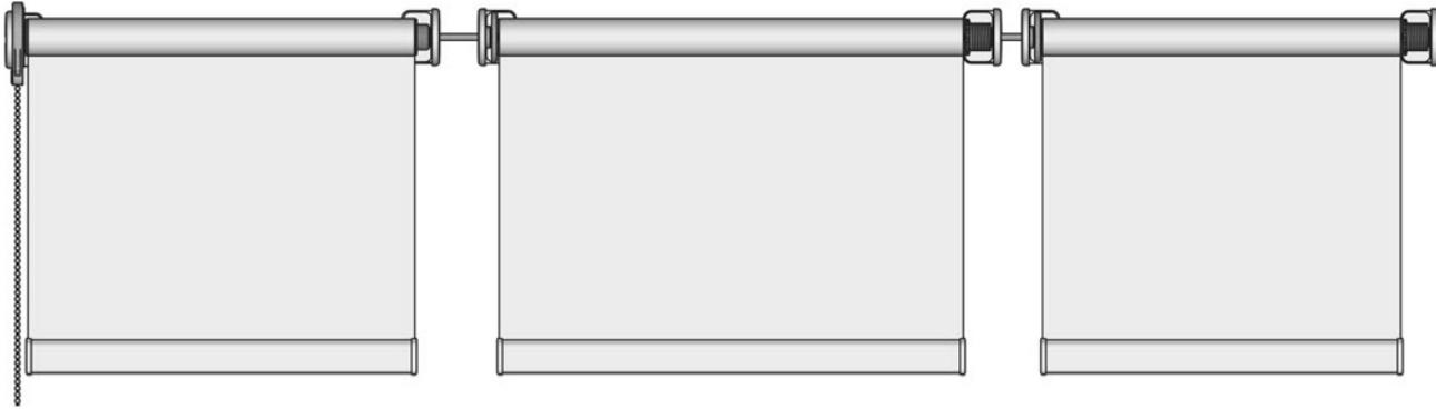
Bedienung mit Elektroantrieb (ELRO-XL max. 48 m<sup>2</sup> gekoppelt)
