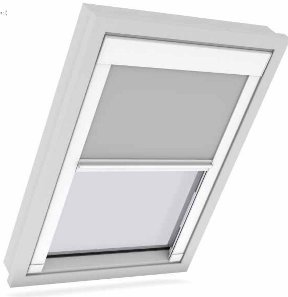
**Skylight-Rollo SKRO-V** nach Maß, die Griffleiste ist mit einem Verschlussgummi versehen, die Seitenführungsschienen gewähren Blick- und Lichtschutz. Der Rollostoff wird mit Kunststoffknoppen in den Seitenführungsschienen fixiert. Diese Anlagen sind für alle gängigen Fenstertypen VELUX®, ROTO® und Sondertypen geeignet.
