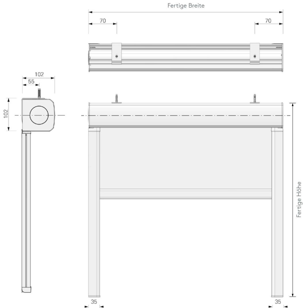
Seitliche Führungsschienen 35 mm
