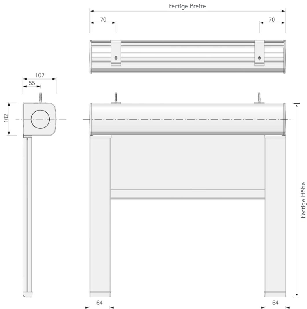
Seitliche Führungsschienen 64 mm
