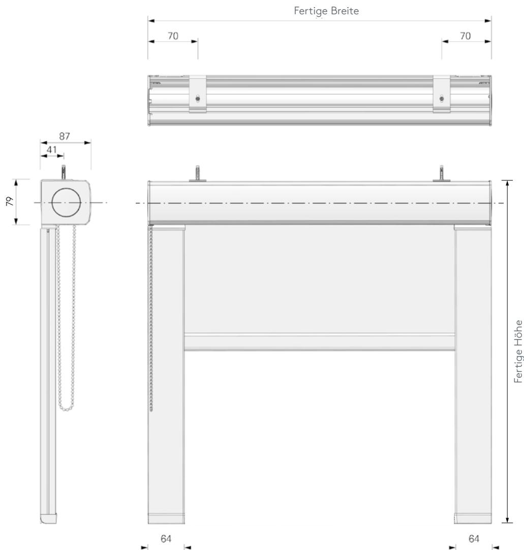
Seitliche Führungsschienen 64 mm
