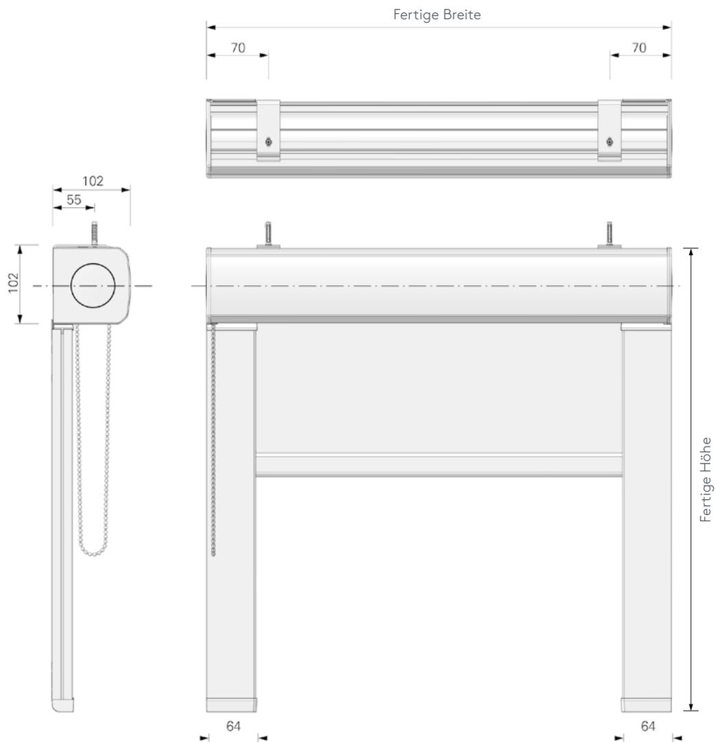
Seitliche Führungsschienen 64 mm
