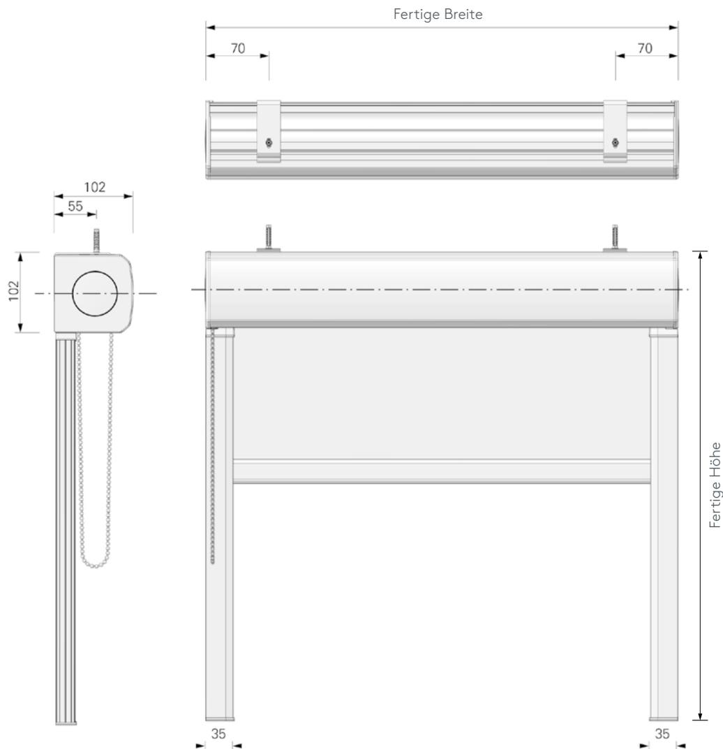
Seitliche Führungsschienen 35 mm
