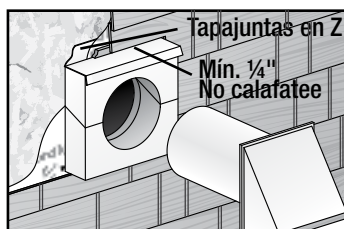
Ilustración 11 Penetración de Bloque
