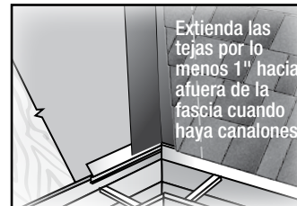
Ilustración 12 Extensión de la Intersección de Limahoyos/Tejas
