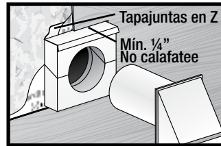
Ilustración 15 Penetración de Bloque
