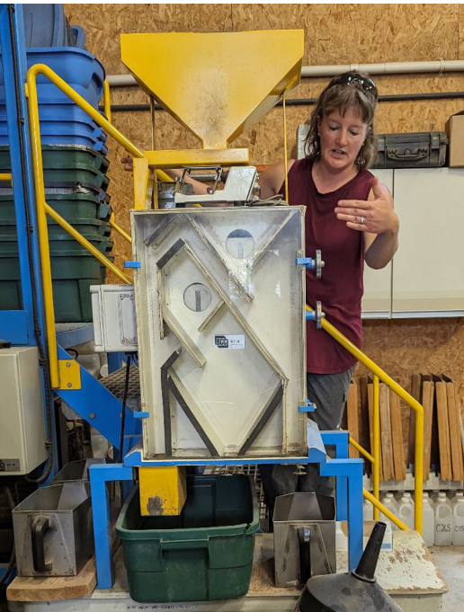
Ci-dessus : démonstration du séparateur à gravité au service forestier de Millson
