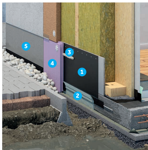
Bauwerksabdichtung im Neubau.
