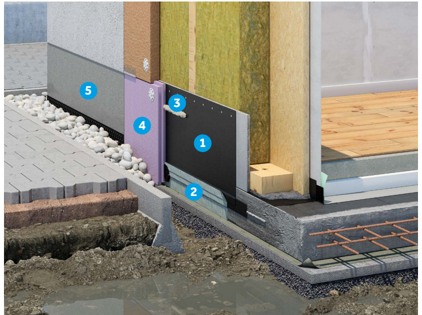
Bauwerksabdichtung im Neubau.
