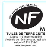
Les caractéristiques certifiées par la marque **NF** Tuiles de terre cuite sont : l'aspect, les caractéristiques géométriques, la résistance à la rupture par flexion, l'imperméabilité, la résistance au gel et la résistance au gel "climat de montagne".
