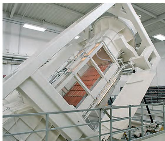
A la pointe de l'innovation, le centre R&D de BMI Group permet de tester et mettre à l'épreuve toutes les tuiles grâce à sa soufflerie "Wind Tunnel" unique en Europe. Celle-ci permet de reproduire en réel les plus sévères conditions climatiques : vents de plus de 170 km/h, pluies.
