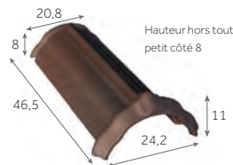
Arêtier d'emboîtement de 40 2,5 au m 3,5 kg/pièce
