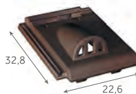
Tuile chatière grillagée (ouverture 13 cm²) 2,5 kg/pièce
