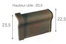
Rive universelle de 33 droite 3 au m 3,4 kg/pièce
