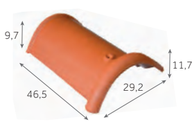
Faîtière/arêtier demi-ronde de 40 ventilée 2,5 au m 4 kg/pièce
