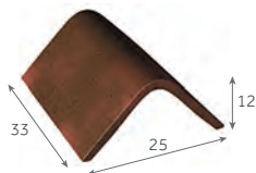
Faîtière bout-à-bout angulaire de 33 3 au m 2,7 kg/pièce
