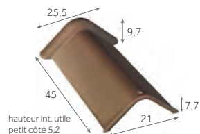
Faîtière de Marseille de 40 (angle 120°) 2,5 au m 3 kg/pièce
