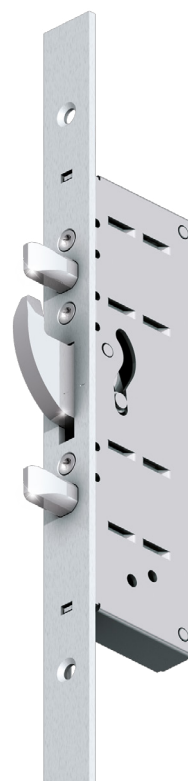
Serrature di Tipo 11: serratura a 3 punti azionata da chiave o maniglia, con catenaccio centrale, superiore e inferiore. Dotata di bullone a doppia sporgenza sia sopra che sotto per una maggiore sicurezza.
