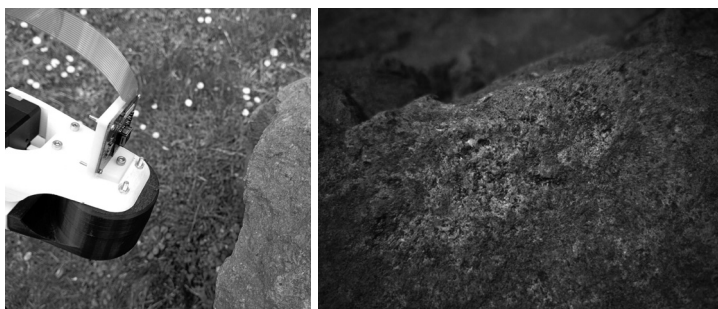
Rys. 4. Po lewej widnieje zdjęcie kamery zamocowanej na chwytaku manipulatora, po prawej przykład wykonanego zdjęcia
