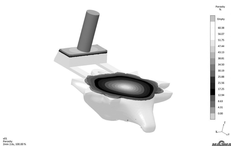
Rys. 3. Miejsce powstania wady związanej ze skurczem metalu
