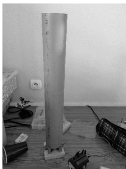
Rys. 8. Rezonator akustyczny zamontowany razem z generatorem plazmy
