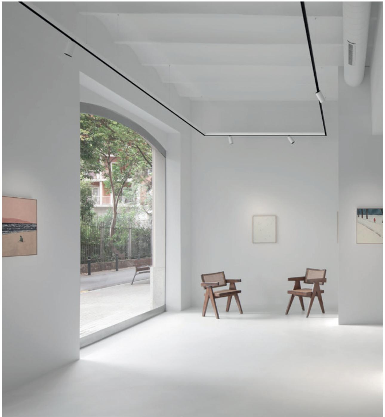
Une ligne minimale de seulement 15mm de largeur, réalisée grâce à la miniaturisation extrême des composants électroniques et des corps optiques. Le Tracking Magnet offre une gamme complète de produits adaptés à tous les besoins, compatibles avec tous les principaux systèmes de variation et FLOS Control®. Son installation magnétique permet une entière liberté de configuration dans l'espace.
