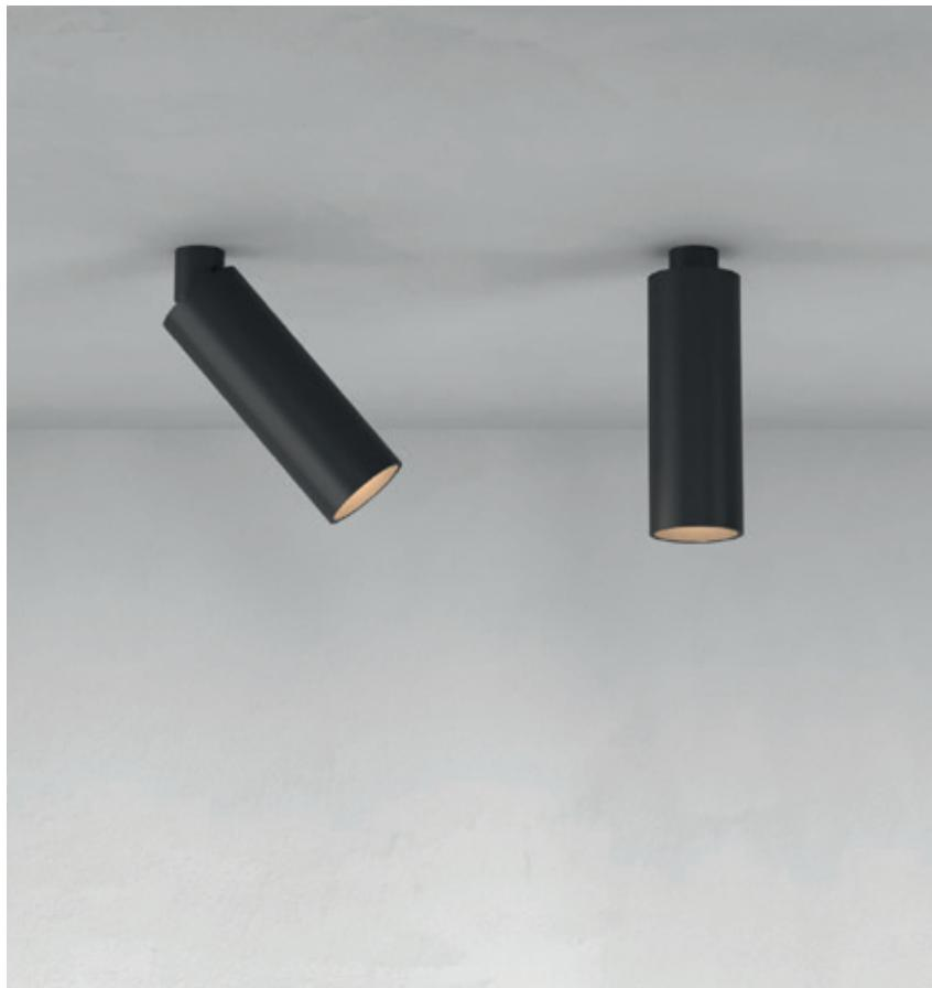
Le groupe optique, placé vers l'arrière sur le corps, cache la source de lumière de la vue tout en contrôlant l'éclairage direct pour un effet de confort total. Le nœud spécial, intégré dans le corps du produit, permet de le retirer et de le diriger sur la base à 60° dans l'axe vertical et à 355° dans l'axe horizontal.
