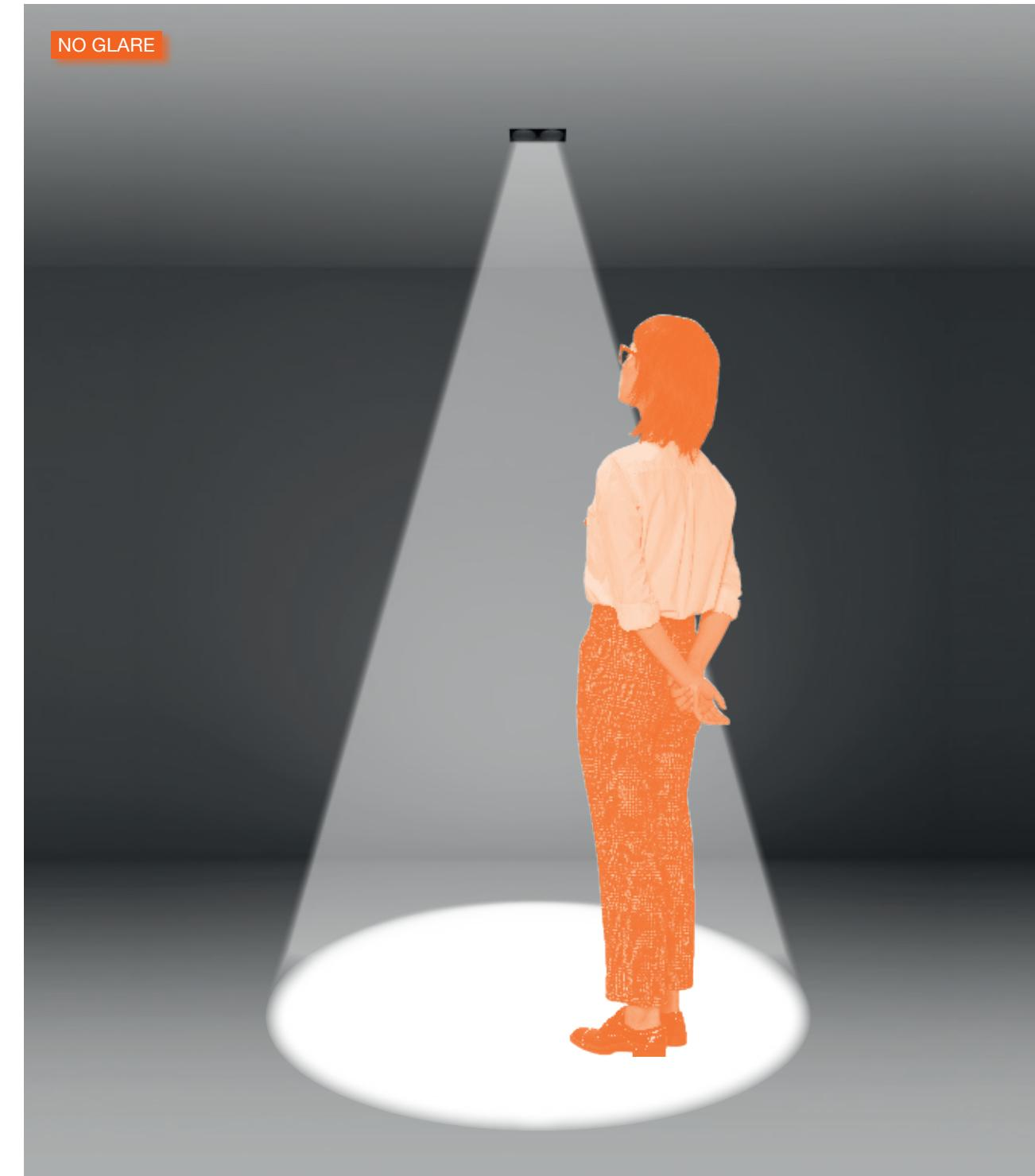
Con la tecnología del Light Shadow que proporciona un cut-off de 45 grados, la máxima integración con la arquitectura se combina con el haz de luz definido e impecable y un apantallamiento total, lo que permite situarse en casi posición cenital y no ser deslumbrado.
