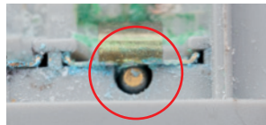
Un connecteur de pile principale contaminé
