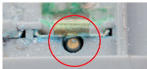
En forurenset hovedbatterikontakt
