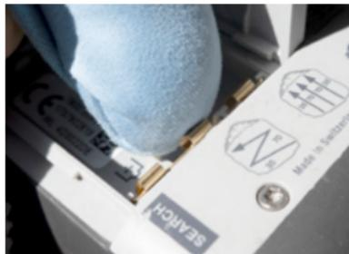
engancharse en el contacto durante su limpieza, lo que llevaría a que el contacto se doble y potencialmente se rompa. Aplique sólo la presión suficiente
