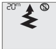
Ancho de banda de búsqueda reducido debido a interferencias.
