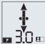
Durante esta fase de la búsqueda, ¡sujete el dispositivo a la altura de la rodilla. Inicialmente su Barryvox le mostrará el primer eje de la búsqueda fina, que se identifica con la pista de aterrizaje en el modelo de aproximación al aeropuerto.
