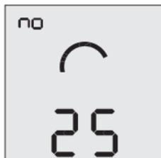
Tan pronto como la palabra “mantenimiento” aparezca en la pantalla, presione y mantenga el botón para activar o desactiva el w-link. Si el ajuste mostrado en “no”, el w-link está desconectado, en el estado activado se muestra la región w-link preprogramada.
