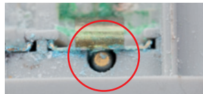
Zanieczyszczone przez wyciek główne złącze baterii.
