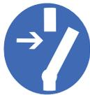
Schalten Sie vor Arbeiten an Modulen diese durch einen Freischalter stromlos, da sonst Lichtbögen entstehen können.
