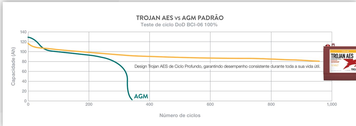
A bateria Trojan AES mantém alta capacidade em ciclos profundos extremos (até 100% DoD) com desempenho consistente ao longo de sua vida útil em comparação com a AGM padrão.
