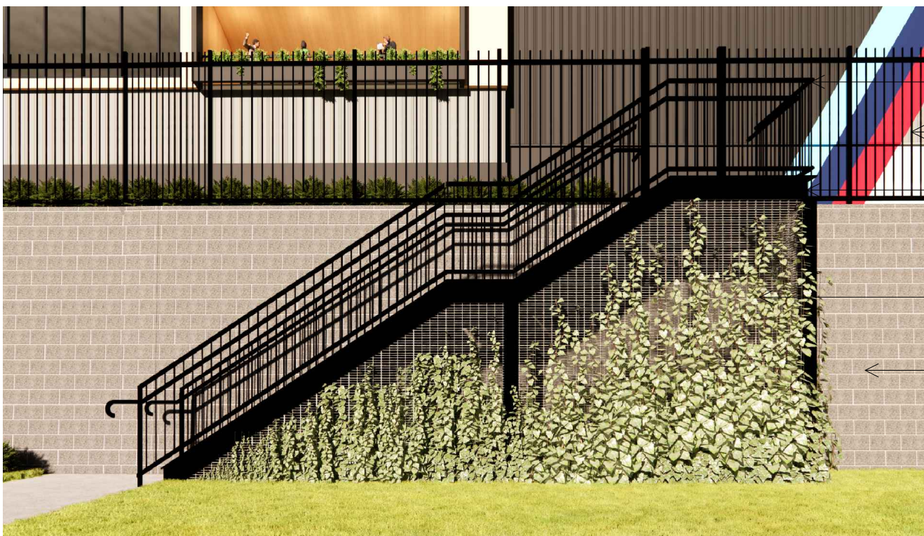
A FIRE EGRESS STAIR (TYP.) N.T.S.
