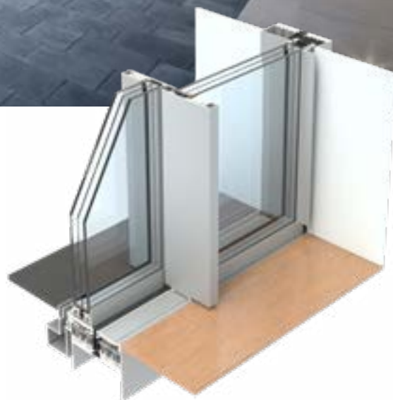
ARTLINE XL, seuil affleurant : Esthétique minimaliste du coulissant avec un montant central très fin.
