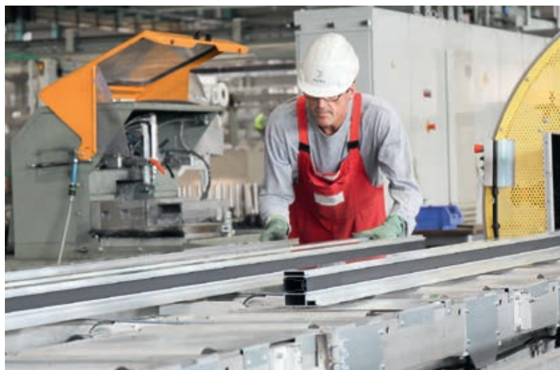
Gefertigt werden die Verbundprofile in Bellenberg an insgesamt drei Maschinenlinien, an denen die Einzelteile mittels maschineller und manueller Hilfe zusammengesetzt werden.
