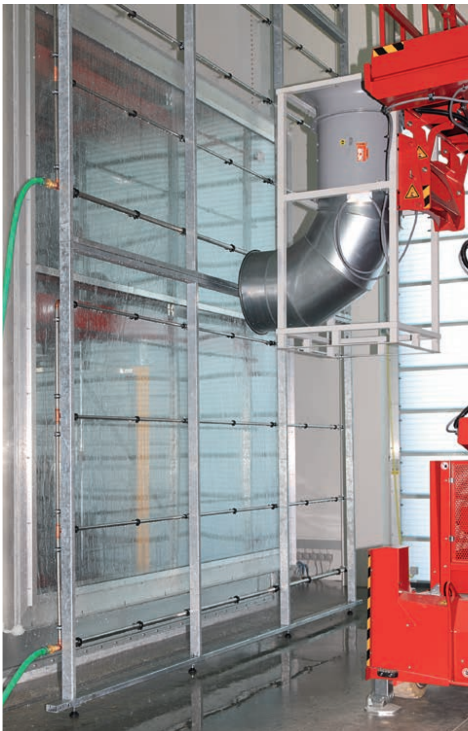
Fassadenprüfstand, Prüfung Schlagregendichtheit
