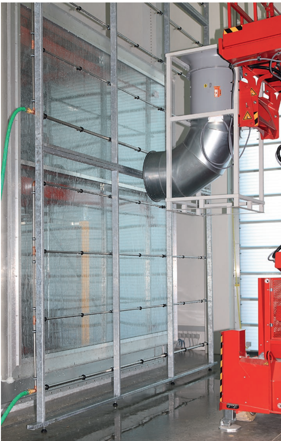
Fassadenprüfstand, Prüfung Schlagregendichtheit
