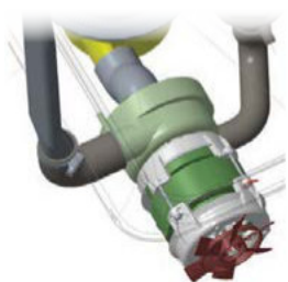
Bomba de lavado de doble salida
