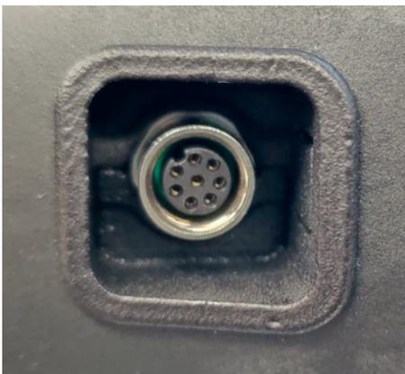
Abbildung 27: 8-polige DIO-Buchse am Roboterarm
