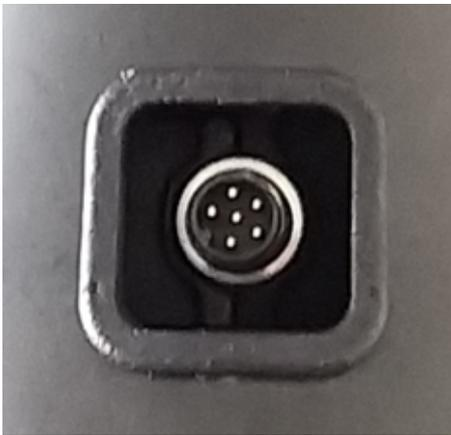
Abbildung 29: 6-polige DIO-Buchse am Roboterarm
