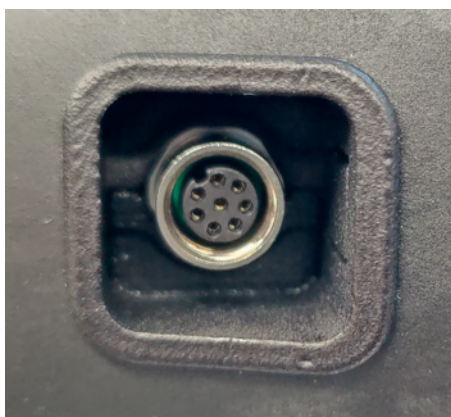
Abbildung 27: 8-polige DIO-Buchse am Roboterarm
