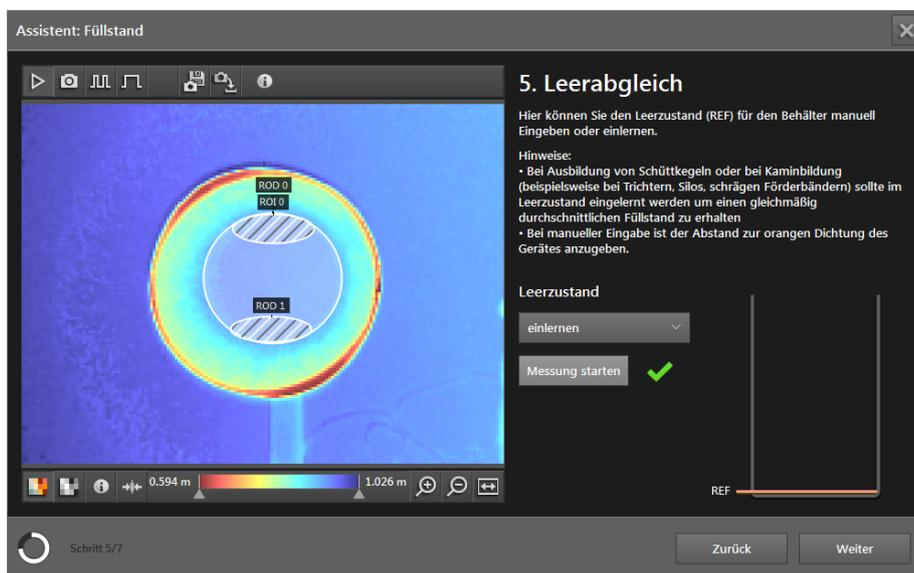
Das Fenster "Leerabgleich" bestimmt die Start- oder Null-Ebene der Füllstand. Diese kann entweder eingelernt (Verwendung eines Durchschnittswertes aus 20 Messungen auf einen leeren Behälter) oder manuell eingegeben werden.
