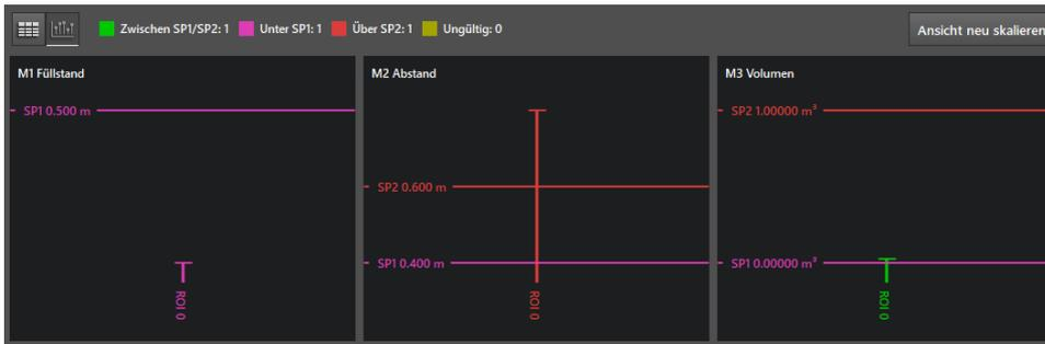
Im Balkendiagramm werden die Prozesswerte der einzelnen ROIs als vertikale Linien angezeigt. Die Farbe der Linie zeigt den Status der ROIs an. Die Schaltschwellen werden durch horizontale Linien dargestellt.
