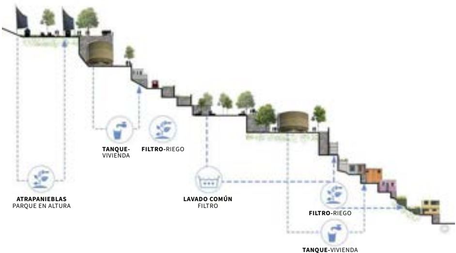
07. EL CORTE EXPLICATIVO DEL SISTEMA DE AGUA PROCURA EL MAYOR PROVECHO DEL RECURSO DESDE SUS DISTINTAS FUENTES
