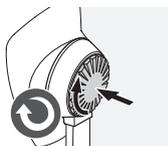
Плотно прижать штифт и повернуть его немного по часовой стрелке до щелчка.
