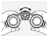
Durch Drehen des Fokussierades können Sie jedes Objekt von der kürzesten Einstellentfernung (siehe technisches Datenblatt) bis unendlich scharf stellen.
