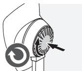
Premere il perno energicamente e ruotarlo leggermente in senso orario fino a che non scatta in posizione.
