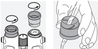
Bei starker Verschmutzung (z. B. Sand) sind die Drehaugenmuscheln komplett ab-schraubbar und somit einfachst zu reinigen. Bitte beachten Sie, dass die Fernglas Leder-armierung, die CL Companion Habicht Tasche und der CL Companion Habicht Trageriemen nicht für die Reinigung mit
