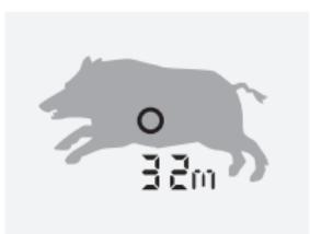
A mozgó célpontok távolsága folyamatosan mérhető pástázó módban. A műszer automatikusan pástázó módba vált, ha 3 másodpercnél tovább lenyomva tartja a mérőgombot.
