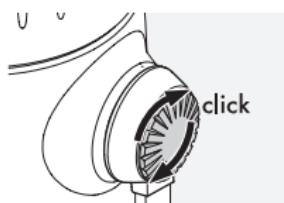
Sprostite zatič in gumb še naprej obračajte v smeri urinega kazalca, da se zaskoči.
