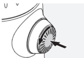
Вдавить кнопку и повернуть ее против часовой стрелки ( $90^{\circ}$ ).
