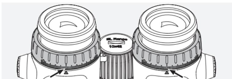
b. Zatim vratite prstene za izjednačavanje dioptrije na njihovo mjesto. Ako je vid na oba oka jednako oštećen, namjestite dalekozor na način opisan u odjeljku 3.4. Zaslon mora biti u oštrom fokusu da bi se postigla najbolja moguća linija skale za određivanje raspona.
