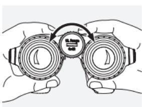
Otočením zaostrovacieho kolieska môžete zaostríť na ľubovoľný objekt od najkratšej zaostrovacej vzdialenosť (pozrite list s technickými údajmi) až do nekonečna.
