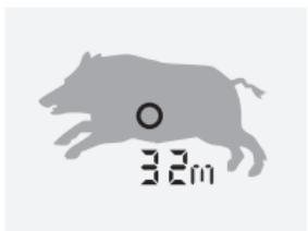
V režimu skenování dochází k průběžnému měření pohyblivých cílů. Zařízení se automaticky přepne do režimu skenování, pokud stisknete a podržíte tlačítko měření po dobu delší než 3 sekundy.
