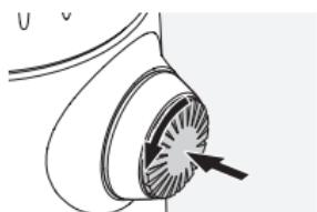
Pritisnite na gumb in ga zasučite v nasprotni smeri urinega kazalca ( $90^{\circ}$ ).
