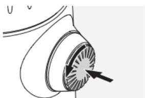
Pritisnite okruglu ručicu i okrenite je u smjeru suprotnom od kazaljke na satu ( $90^\circ$ ).
