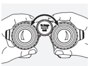
Rotirea rotiței de focalizare vă permite să focalizați pe orice obiect de la cea mai mică distanță de focalizare posibilă (a se vedea fișa de date tehnice) la infinit.
