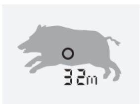
Premikajoči predmeti se v načinu skeniranja nenehno merijo. Naprava se samodejno preklopi v način skeniranja, če pritisnete in več kot 3 sekunde držite gumb za merjenje.
