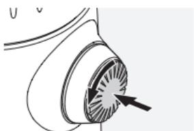
Pritisnite dugme i rotirajte ga u smeru suprotnom od kretanja kazaljki na satu ( $90^\circ$ ).
