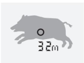
Pokretnе se mete neprekidno mjere u načinu skeniranja. Instrument se automatski prebacuje na način skeniranja ako pritisnete i držite gumb za mjerjenje duže od 3 sekunde.
