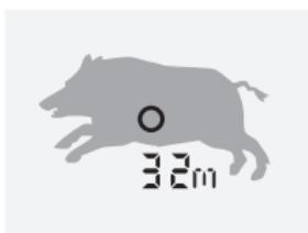
В режиме сканирования происходит непрерывное измерение расстояния до движущихся целей. Режим сканирования включается автоматически, если нажать кнопку измерений и удерживать ее дольше 3 секунд.
