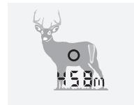
Krátkým stisknutím tlačítka měření zobrazíte cílovou značku. Po uvolnění tlačítka se na displeji zobrazí měření vzdálenosti.
