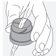
**Čistenie ochranného krytu.** Použite súpravu čistiaceho prostriedku a kefky (dodáva sa so zariadením). Zavorte kryty okulára aj objektívu. Navlhčite kefkou a kruhovými pohybmi naneste čistiaci prostriedok. Jemný kryt vyčistite. Opláchnite ďalekohľad čistou vodou a opatrne ho nechajte vyschnúť. Ak dôjde k namočeniu optiky, jemnými dotykmi čistou handričkou ju osušte tak, aby ste predišli jej poškriabaniu. Kefku dôkladne opláchnite a nechajte súpravu čistiaceho prostriedku a kefky vyschnúť.
