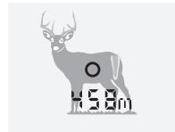
Kratko pritisnite gumb za merjenje, da se prikaže ciljna oznaka. Ko sprostite gumb, se meritev dometa prikaže na zaslonu.
