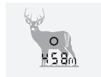
Krátkym stlačením tlačidla merania zobrazte cieľovú značku. Po uvoľnení tlačidla sa na displeji zobrazí meranie vzdialenosťí.
