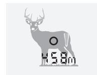
Naciśnij krótko przycisk pomiarowy, aby wyświetlić znak celowniczy. Po zwolnieniu przycisku wynik pomiaru odległości zostanie pokazany na wyświetlaczu.
