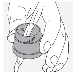
**Curățarea carcasei de protecție.** Utilizați kitul format din săpun și perie (inclus). Acoperiți ocularul și obiectivul cu capacele de protecție. Înmulajați peria și aplicați săpunul, folosind mișcări circulare, pentru a curăța cu atenție carcasa. Clătiți binocul cu apă curată și uscați cu grijă. În cazul în care elementele optice se udă, uscați-le cu ajutorul unei pânze curate pentru a împiedica orice zgâriere. Clătiți bine peria și puneți la uscat kitul format din săpun și perie.
