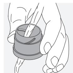
**Čišćenje zaštitnog kućišta.** Upotrijebite komplet sapuna i četkice (isporučeno). Zatvorite poklopce na okulatoru i leće objektiva. Namočite četkicu i nanesite sapun pomoću kružnih pokreta za nježno čišćenje kućišta. Isperite dalekozor čistom vodom i pažljivo ga osušite. Ako se optika smoči, osušite je tapanjem suhom krpicom da biste izbjegli ogrebotine. Temeljito isperite četkicu i ostavite komplet sapuna i četkice da se osuši.
