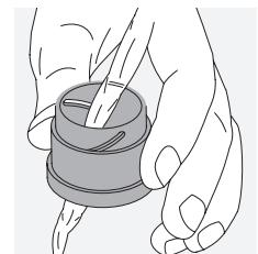
**Čišćenje zaštitnog kućišta.** Koristite komplet sapuna i četke (isporučeno). Zatvorite poklopce okulara i objektiva. Navlažite četku i nanesite sapun kružnim pokretima kako biste nežno očistili kućište. Isperite dvogled čistom vodom i pažljivo ga ostavite da se osuši. Ukoliko se optičke komponente navlaže, blago ih dodirnjite čistom krpom kako biste sprečili pojavu ogrebotina. Temeljno isperite četku i ostavite komplet sapuna i četke da se osuše.
