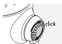
Otpustite pritisak zatika i nastavite ga okretati u smjeru kazaljke na satu dok ne začujete klik.
