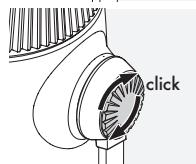
Otpustite pritisak zatika i nastavite ga okretati u smjeru kazaljke na satu dok ne začujete klik.
