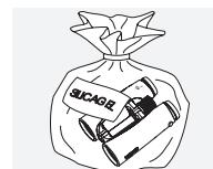
Produkt skladujte v dodanej taške na dobre vetranom mieste. Ak dôjde k namočeniu produktu, nechajte ho najskôr vyschnúť. V tropických oblastiach alebo oblastiach s vysokou vlhkosťou odporúčame zariadenie skladovať vo vzduchotesnej nádobe spoločne s činidlom pohlcujúcim vlhkosť (napr. silikagélem).
