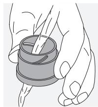
**Čišćenje zaštitnog kućišta.** Upotrijebite komplet sapuna i četke (isporučen). Zatvorite poklopce okulara i leća objektiva. Prie čišćenja uklonite bateriju i zatvorite odjeljak za bateriju. Navlažite četku i kružnim pokretima nanesite sapun kako biste nježno očistili kućište. Zatim isperite uređaj čistom vodom i pažljivo ga osušite. Ako se optika smoči, osušite je čistom tkaninom kako biste sprječili nastanak ogrebotina. Temeljito isperite četku i pričekajte da se osuši komplet sapuna i četke.
