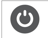
Uredaj možete uključiti ili isključiti tako da pritisnete i držite gumb za UKLJUČIVANJE/ISKLJUČIVANJE. Ako je uređaj uključen, kratkim pritiskom ovog gumba deaktivira se ili ponovno aktivira prikaz.
