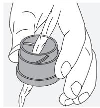
**Очистка корпуса.** Используйте набор из мыла и щетки (входит в комплект поставки). Закройте крышками окуляры и объективы. Перед очисткой извлеките батарею и закройте батарейный отсек. Смочите щетку, намыльте ее и протрите корпус круговыми движениями для бережной очистки. Затем сполосните бинокль чистой водой и тщательно высушите. Если оптика стала влажной, протрите ее насухо чистой тканью, чтобы не поцарапать. Хорошо промойте щетку и высушите набор из мыла и щетки.
