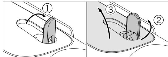
Pentru a introduce bateria în dispozitiv, mai întâi trebuie să deschideți compartimentul bateriei. Acesta se află la baza dispozitivului. Pentru a deschide compartimentul bateriei, întoarceți sistemul de închidere tip baionetă în poziție verticală (1), roțiți-l 90° în sens antiorar spre stânga (2) și deschideți capacul compartimentului bateriei (3).
