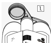
1. Zatvorite poklopac leće objektiva i ostavite lijevi poklopac otvoren.
