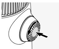
Pritisnite okruglu ručicu i okrenite je u smjeru suprotnom od kazaljke na satu (90°).
