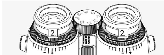
2. Поверните оба кольца диоптрической настройки против часовой стрелки до упора.
