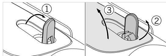
Prije ugradnje baterije u uređaj morate otvoriti odjeljak za bateriju. Nalazi se s donje strane uređaja. Kako biste otvorili odjeljak za bateriju, zakrenite kopču prema gore u okomiti položaj (1), okrenite je za 90° u smjeru suprotnom od smjera kazaljke na satu ulijevo (2) i otvorite poklopac odjeljka za bateriju (3).
