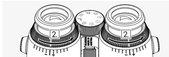
2. Obróć oba pierścienie regulacji dioptrii w lewo do oporu.
