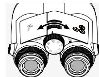
Obracając pokrętło do regulacji ostrości, można ustawić optymalną ostrość na dowolnym obiekcie od najmniejszej odległości ogniskowania (zob. arkusz danych technicznych) do nieskończoności.
