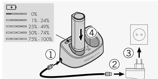
Zařízení AX VISIO se dodává s nainstalovanou RB baterií. Před prvním použitím zařízení ji úplně nabijte (viz 4.2). Síťový adaptér 3 není součástí dodávky.
