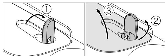
Da vstavite baterijo v napravo, najprej odprite predel za baterijo. Ta se nahaja na spodnjem delu naprave. Da odprete predel za baterijo, ročico za zaklep potisnite v navpični položaj (1), jo obrnite v nasprotni smeri urinega kazalca za 90° (2) ter odprite pokrov predela za baterije (3).
