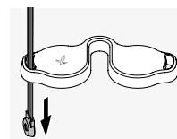
Aby zamontować osłonę okularu lub inne akcesoriów, przeciągnij pasek przez otwór w osłonie.
