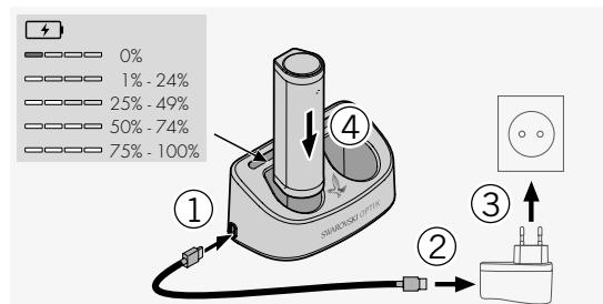
Az AX VISION-ba gyárilag be van helyezve az RB akkumulátor. Az eszköz első használata előtt töltse fel teljesen az akkumulátort! (lásd 4.2).
