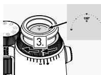
3. Теперь смотрите правым глазом в правый окуляр и поворачивайте кольцо диоптрической настройки по часовой стрелке, пока изображение не станет четким. Затем полностью снимите крышку для объективов.
