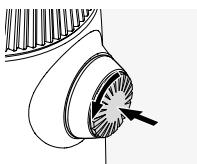
Вдавить кнопку и повернуть ее против часовой стрелки (90°).
