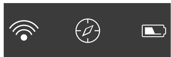
В строке состояния отображается информация о текущем состоянии AX VISIO. Слева можно видеть, есть ли в данный момент активное соединение со смартфоном по Bluetooth или Wi-Fi. В середине показано приложение, выбранное в данный момент с использованием колеса выбора режима. Справа отображается уровень заряда батареи. Стока состояния автоматически исчезает через пять секунд после запуска AX VISIO, изменения приложения с использованием колеса выбора режима или повторной активации дисплея.
