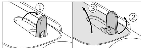
Чтобы вставить батарею в устройство, нужно сначала открыть батарейный отсек. Он расположен с нижней стороны устройства. Переверните байонетный замок в вертикальное положение (1), поверните его на 90° против часовой стрелки влево (2) и откройте крышку батарейного отсека (3).
