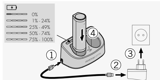
AX VISIO se isporučuje s ugrađenom baterijom RB. Napunite bateriju u potpunosti prije prve upotrebe uređaja (vidi 4.2). Strujni adapter 3 nije isporučen.
