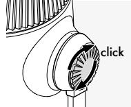
Sprostite zatič in gumb še naprej obračajte v smeri urinega kazalca, da se zaskoči.
