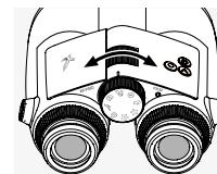
Rotirea rotiței de focalizare vă permite să focalizați pe orice obiect de la cea mai mică distanță de focalizare posibilă (a se vedea fișa de date tehnice) la infinit.
