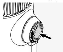
С усилием нажать на кнопку и немного повернуть ее по часовой стрелке.
