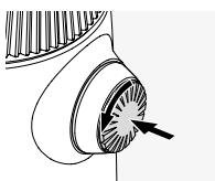
Pritisnite dugme i rotirajte ga u smeru suprotnom od kretanja kazaljki na satu ( $90^\circ$ ).
