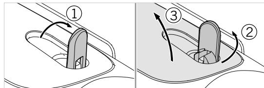
Chcete-li vložit baterii do zařízení, nejprve je třeba otevřít prostor pro baterii. Nachází se na spodní straně zařízení. Otevřete prostor pro baterii tak, že vykloníte bajonetový uzávěr do svíslé polohy (1), otočíte ho doleva o 90° proti směru hodinových ručiček (2) a otevřete kryt prostoru pro baterii.
