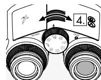
4. Koristite točkić za fokusiranje da biste fokusirali desni optički kanal na udaljenom objektu (držite levo oko zatvoreno).
