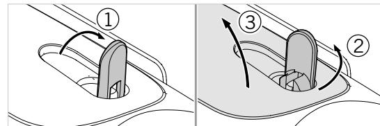
Az akkumulátor eszközbe való behelyezéséhez először nyissa ki az akkumulátor tartó rekeszt. Ez az eszköz alján található. Az akkumulátor tartó rekesz kinyitásához pattintsa fel a bajonettszárat függőleges helyzetbe (1), fordítsa el az óramutató járásával ellenére 90°-kal (2), és nyissa ki az akkumulátor tartó rekeszt (3).
