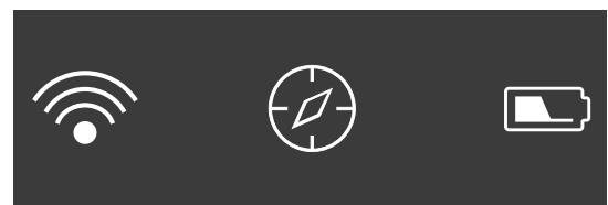
Pasek stanu pokazuje informacje o aktualnym stanie urządzenia AX VISIO. Po lewej stronie widoczna jest informacja o aktywnym połączeniu ze smartfonem przez Bluetooth lub Wi-Fi. Pośrodku wyświetlana jest aplikacja, na którą aktualnie ustawione jest pokrętło do wyboru trybu. Po prawej stronie widoczny jest aktualny stan baterii. Pasek stanu zmienia automatycznie po pięciu sekundach od włączenia AX VISIO, zmianie aplikacji na pokrętłe do wyboru trybu lub ponownym włączeniu wyświetlacza.
