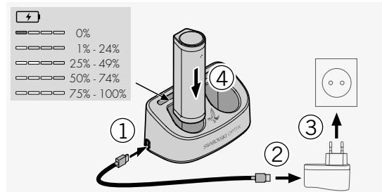
AX VISIO este furnizat cu bateria RB montată. Vă rugăm să încărcați complet bateria înainte de prima utilizare a dispozitivului (vezi 4.2).
