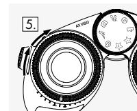
4. Utilizați rotița de focalizare pentru a focaliza canalul drept pe un obiect aflat la distanță (țineți ochiul stâng închis).
