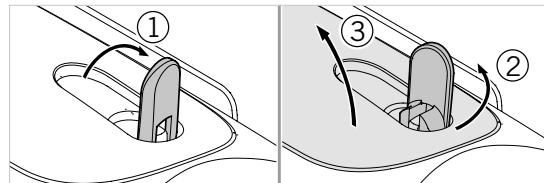
Da biste ubacili bateriju u uređaj, prvo morate da otvorite odeljak za bateriju. Nalazi se na dnu uređaja. Da biste otvorili odeljak za bateriju, okrenite bajonet kvačicu u vertikalni položaj (1), okrenite je 90° uлево u smeru suprotnom od kretanja kazaljki na satu (2) i otvorite poklopac odeljka za bateriju (3).
