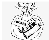
Skladujte produkt v dodané brašně na dobře větraném místě. Pokud dojde k namočení produktu, nechte jej nejdřív vyschnout. V tropických oblastech nebo oblastech s vysokou vlhkostí bude nejlepší, pokud budete zařízení skladovat ve vzduchotěsné nádobě společně s činidlem pohlcujícím vlhkost (např. silikagel).
