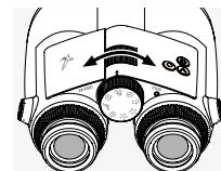
Okrećanje kotačića za fokusiranje omogućuje vam da se fokusirate na bilo koji predmet od najmanje udaljenosti fokusiranja (pogledajte tehničke specifikacije) do beskonačnosti.
