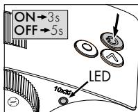
**ZAPNUTÍ:** Stiskněte a alespoň tři sekundy podržte tlačítko vypínače, dokud stavová kontrolka LED nezmění barvu ze žluté na zelenou. Zařízení AX VISIO je nyní zapnuté a spouští se. Stavová kontrolka LED bude asi 30 sekund blikat. Potom bude stavová kontrolka LED svítit nepřerušovaným zeleným světlem. Nyní je zařízení AX VISIO připraveno k použití a displej je aktivní.
