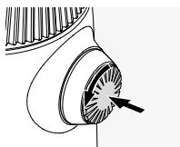
Pritisnite na gumb in ga zasučite v nasprotni smeri urinega kazalca (90 °).
