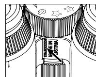
Серийный номер изделия можно найти на нижней стороне устройства между колесом выбора режима и колесом фокусировки. Чтобы серийный номер был хорошо виден, полностью раскройте устройство.
