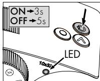
**PORNIREA:** Apăsați și țineți apăsat butonul PORNIRE/OPRIRE timp de cel puțin trei secunde, până când indicatorul de stare cu LED se schimbă din galben în verde. Dispozitivul AX VISIO a fost pornit și intră în funcțiune. Indicatorul de stare cu LED clipește timp de aproximativ 30 de secunde. După aceea, indicatorul de stare cu LED devine permanent verde. Dispozitivul AX VISIO este acum gata de utilizare, iar ecranul este activ.
