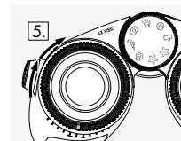
4. Upotrijebite kotačić za fokusiranje da biste fokusirali desni kanal na udaljeni predmet (držite lijevo oko zatvorenim).
