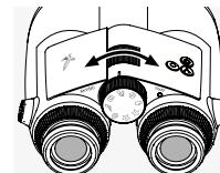
Okretanje točkića za fokusiranje vam omogućava da fokusirate svaki predmet od najkraće udaljenosti fokusiranja (pogledajte dokument s tehničkim specifikacijama) do beskonačnog.
