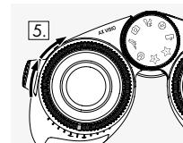
4. Pomocou zaostrovacieho kolieska zaostrite pravý kanál na vzdialenosť objektu (nechajte ľavé oko zatvorené).
