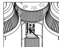
Numer seryjny produktu znajduje się na spodzie urządzenia pomiędzy pokrętłem do wyboru trybu i pokrętłem do regulacji ostrości. Aby numer seryjny był dobrze widoczny, należy całkowicie otworzyć urządzenie.
