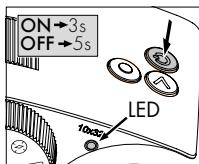
**VKLOP:** Pritisnite in držite gumb za VKLOP/IZKLOP vsaj tri sekunde, dokler se LED-lučka za prikaz stanja ne spremeni iz rumene v zeleno. Naprava AX VISIO je vklopljena in se zaganja. LED-lučka za prikaz stanja utripa približno 30 sekund. Nato LED-lučka za prikaz stanja sveti zeleno. Naprava AX VISIO je pripravljena za uporabo in zaslon je vklopljen.
