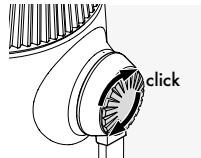
Otpustite pritisak zatika i nastavite ga okretati u smjeru kazaljke na satu dok ne začujete klik.
