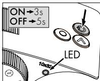
**ВКЛЮЧЕНИЕ:** Нажмите кнопку ВКЛ/ВыКЛ и удерживайте ее как минимум 3 секунды, пока светодиодный индикатор состояния не изменит цвет с желтого на зеленый. AX VISIO теперь включен и запускается. Светодиодный индикатор состояния мигает примерно 30 секунд. Затем он будет постоянно гореть зеленым цветом. Теперь AX VISIO готов к использованию, и дисплей активен.
