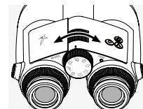
Otočením zaostrovacieho kolieska môžete zaostríť na ľubovoľný objekt od najkratšej zaostrovacej vzdialnosti (pozrite list s technickými údajmi) až do nekonečna.
