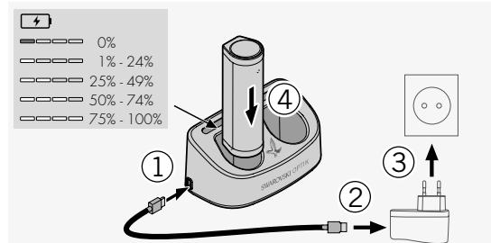
AX VISIO se isporučuje sa instaliranim RB baterijom. Pre korišćenja uređaja po prvi put, napunite bateriju do kraja (pogledajte 4.2).
