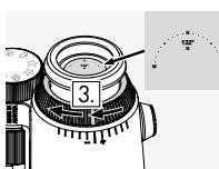
3. Sada desnim okom gledajte kroz desni okulator i okrećite prsten za izjednačavanje dioptrije u smjeru suprotnom od kazaljke na satu dok zaslon ne postane oštar. Zatim potpuno uklonite poklopac leće objektiva.
