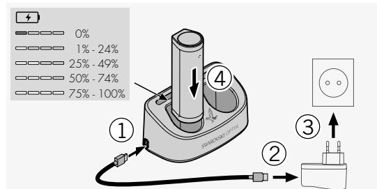
Urządzenie AX VISIO jest dostarczane z zainstalowaną baterią ładowalną RB. Przed pierwszym użyciem urządzenia należy naładować baterię do pełna (zob. 4.2). Zasilacz sieciowy 3 nie wchodzi w skład zestawu.
