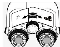
Otočením zaostřovacího kolečka můžete zaostřít na libovolný objekt od nejkratší zaostřovací vzdálenosti (viz list s technickými údaji) až do nekonečna.
