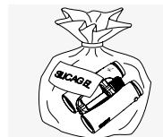
Храните изделие в прилагаемой сумке, в хорошо проветриваемом месте. Если изделие влажное, сначала необходимо его высушить. В тропических районах или в областях с высокой влажностью воздуха лучше хранить его в герметичном контейнере с влагопоглотителем (таким как силикагель).
