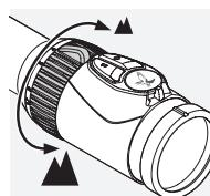
Draai de vergrotingsstelring tot maximaal 180° om de gewenste vergroting traploos in te stellen. De schaal op de stelring maakt een eenvoudig aflezen van de instelling mogelijk. Voor een betere oriëntering heeft de licht goprofileerde stelringomhulling een neusje.
