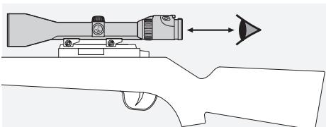
Ställ in korrekt ögonsavstånd för kikarsikten som monteras på vapen (måttet hittar du i det tekniska databladet).
