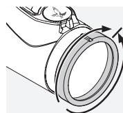
Draai de dioptiestelring eerst helemaal naar links (tegen de klok in) en vervolgens naar rechts, tot het dradenkruis de optimale scherpte heeft. Het correctiereik is afhankelijk van het specifieke model. Meer informatie hierover vind je op het bijgevoegde technische gegevensblad.
