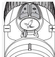
In dem von Ihnen gewählten Modus können Sie nun die Helligkeit mittels der +/ - Tasten einstellen. Zum schnellen Finden der optimalen Helligkeit können Sie die Taste gedrückt halten (Dauerimpuls). Durch einmaliges Drücken der Tasten (Einzelimpuls) nehmen Sie die Feinjustierung vor.
