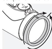
D'abord, tournez la bague d'ajustement dioptrique entièrement vers la gauche (sens inverse des aiguilles d'une montre), puis vers la droite, jusqu'à ce que la mise au point du réticule soit bien nette. La plage de réglage dépend du modèle de lunette. Vous trouverez d'autres informations dans la fiche technique ci-jointe.
