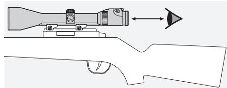
Indstil øjenafstanden korrekt for et sigte monteret på et våben (se det tekniske dataark for målingerne).
