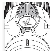
Vous pouvez maintenant régler le niveau de luminosité du mode sélectionné à l'aide des boutons +/-.
