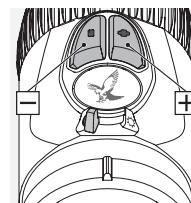
Nyt kirkkautta voidaan säätää valitussa tilassa painikkeilla +/- . Ihanteellinen kirkkaustaso voidaan saavuttaa nopeasti painamalla ja pitämällä yhtiö painiketta painettuna (pitkä pulssi). Tarkkoja säätöjä tehdään painamalla jompaakumpaa painiketta kerran (yksittäinen pulssi).
