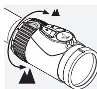
Drej indstillaRingen til forstørrelse helt op til 180° for at opnå den ønskede forstørrelse. Indstillingen foretages løbende. Skalaen på indstillaRingen gør det nemt at aflæse indstillingen.
