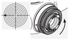
Tournez la bague moletée extérieure de la tourelle latérale dans le sens de la flèche R (sens inverse des aiguilles d'une montre).
