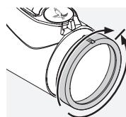
Drej først dioptriindstillaRingen helt til venstre (mod uret), og derefter til højre, indtil sigtet viser optimal skarphed. Indstillingsområdet afhænger af den individuelle model. Du kan finde flere oplysninger i det vedlagte tekniske dataark.
