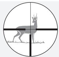
Bei Änderung der Vergrößerung bleibt das Absehen gleich groß – es wird zwar die Größe des Bildes, nicht aber die des Absehens verändert. Selbst bei hohen Vergrößerungen wird nur wenig vom Ziel verdeckt. Ein Schätzen der Entfernung mit Hilfe des Absehens ist nur bedingt möglich.
