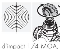
b) ... dans le sens des aiguilles d'une montre lorsque l'impact est haut pour la correction souhaitée du point d'impact 1/4 MOA, 1/8 MOA ou 0,5 cm/100 m - voir les marques sur la tourelle supérieure).
