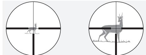
En cas de changement du grossissement, le réticule reste inchangé; la dimension de l'image est certes modifiée, mais pas celle du réticule. Même en cas de forts grossissements, la cible est à peine cachée. Une estimation de la distance à l'aide du réticule n'est possible que sous réserve.
