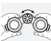
Ved at dreje på fokuseringshjulet kan du stille skarpt på et ethvert objekt fra den korteste indstillingsafstand (se det tekniske datablad) til uendeligt.
