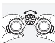
Durch Drehen des Fokussierrades können Sie jedes Objekt von der kürzesten Einstellentfernung (siehe technisches Datenblatt) bis unendlich scharf stellen.
