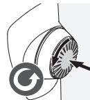
Pressez le bouton vers l'intérieur et tournez-le dans le sens inverse des aiguilles d'une montre (90°).
