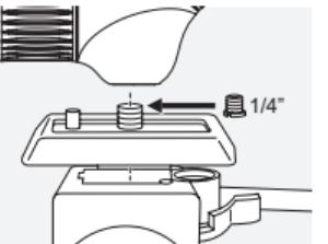
ATC/STC má spojovací závit  $\frac{3}{8}$ " UNC. Vložené puzdro redukuje závit na  $\frac{1}{4}$ ." UNC. Závit je preto možné použiť na montáž adaptérovej dosky a teleskop je kompatibilný so všetkými bežnými hlavami statív.
