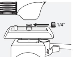
Zařízení ATC/STC je vybaveno  $\frac{3}{8}$ " UNC závitem pro připojení. Vložená objímka redukuje závit na  $\frac{1}{4}$ " UNC. Díky tomu lze závit použít k montáži desky adaptéra a teleskop je kompatibilní se všemi běžnými hlavami stativů.
