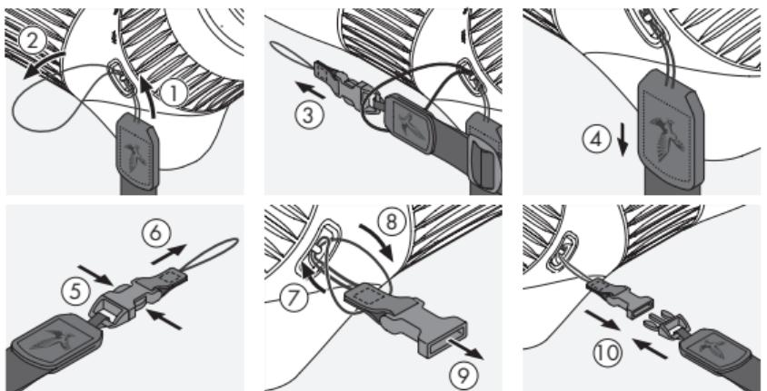
Na drugi strani sprostite konec mehanizma s sponko (5+6) in zanko potisnite skozi držalo zanke (7). Nato končni del mehanizma za zapenjanje potegnite skozi zanko 8, jo zategnite 9 in končni del zapnite na drugi del stranskega nosilnega jermena 10.
