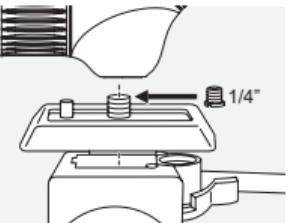
Az ATC/STC  $\frac{3}{8}$ "-es UNC-foglalatmenettel rendelkezik. A behelyezett átalakító a következőre csökkenti a menet méretét:  $\frac{1}{4}$ ." UNC. A foglalat ezáltal használható adapterlap felszereléséhez, és a teleszkóp az összes elterjedt állványfejjel kompatibilis.
