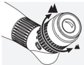
Sprememba povečave: z obračanjem namestitvenega obročka v desno smer povečate povečavo, z obračanjem v levo pa se povečava zmanjšuje. Indeksna oznaka prikazuje trenutno nastavitev povečave.
