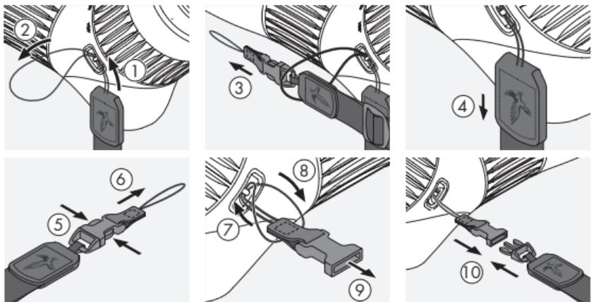
Po drugiej stronie należy odpiąć koniec paska z częścią klamry (5+6) i przełożyć pętlę przez zaczep (7). Następnie należy przeciągnąć koniec przez pętlę (8), zaciągnąć (9) i spiąć z drugą częścią klamry na końcu bocznego paska nośnego (10).
