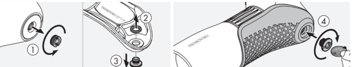
Шаг 3: Прикрепите накладку к нижней части зрительной трубы с использованием крепежного винта.
