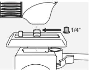
ATC/STC ima UNC spoj s navojem od  $\frac{3}{8}$ ". Tuljac koji je umetnut smanjuje navoj na  $\frac{1}{4}$ " UNC. Navoj se zato može upotrebjavati za montiranje ploče prilagodnika i ciljnik za uočavanje kompatibilan je sa svim uobičajenim glavama stalka.
