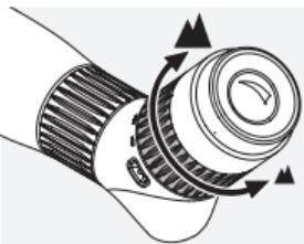
Zmena zväčšenia: otáčaním nastavovacieho krúžka doprava sa zväčšenie zvyšuje, otáčaním doľava sa zväčšenie znižuje. Indexová značka zobrazuje aktuálne nastavenie zväčšenia.
