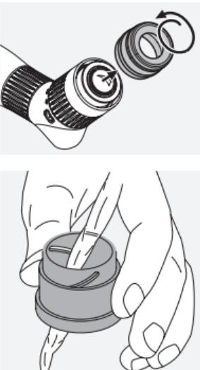
A teleszkóp optikai tökéletességének hosszú távú megőrzése érdekében védje az üvegfelületeket a szennyeződéstől, olajtól és zsírtól. Az optika megtisztításához először távolítsa el a durvább szennyeződéseket a lencsetisztító ecsettel. A fennmaradó szennyeződések eltávolításához lehessen finoman a lencsére, majd a tisztítókendővel tisztítsa le a felületet.
