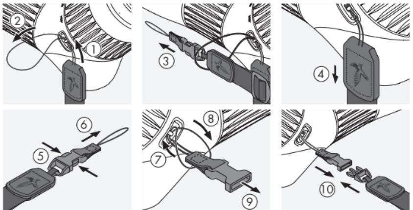
Na druhej strane uvoľnite koniec zacvakávacieho mechanizmu (5+6) a prevlečte slučku cez držiak slučky (7). Potom pretiahnite koniec cez slučku 8, dotiahnite ju 9, a pripojte svorku k druhému koncu bočného remeňa 10.
