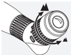
Změna zvětšení: otočením nastavovacího kolečka doprava zvýšte zvětšení, otočením kolečka doleva zvětšení snížte. Značka označuje aktuální nastavení zvětšení.
