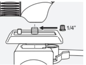
ATC/STC ima navoj za priključivanje dimenzija  $\frac{3}{8}$ " UNC. Čaura koja je ubaćena smanjuje navoj na  $\frac{1}{4}$ " UNC. To znači da se navoj može koristiti za montiranje adapterske ploče i da je durbin kompatibilan sa svim standardnim glavama stativa.
