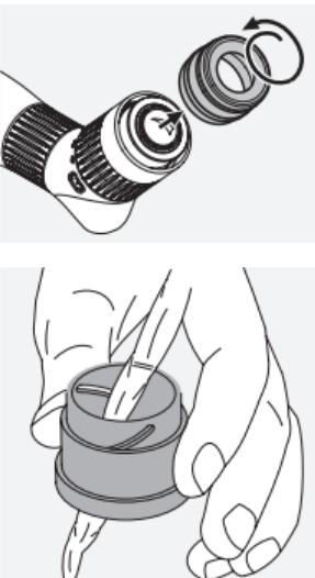
K zajištění dlouhodobé optické výjimečnosti teleskopu byste měli dbát, aby se na skleněné povrchy nedostaly nečistoty, olej ani mazivo. Pokud chcete vyčistit objektiv, nejdřív setřete všechny větší částice nečistot kartáčkem na objektivy. Potom na objektiv lehce dýchněte a vyleštěte jej čisticím hadříkem, abyste odstranili veškeré zbývající nečistoty.
