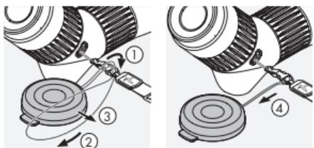
**Opomba:** Ko je nosilni trak nameščen, se lahko pokrov leče objektiva pritrdi na nosilni trak.
