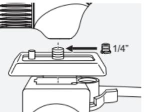
ATC/STC ma złączkę gwintowaną  $\frac{3}{8}$ " UNC. Umieszczona w niej tuleja zmniejsza średnicę gwintu do  $\frac{1}{4}$ " UNC. Dzięki temu złączkę można użyć do zamocowania płytki adaptera, która sprawia, że luneta obserwacyjna pasuje do główic wszystkich najczęściej używanych statywów.
