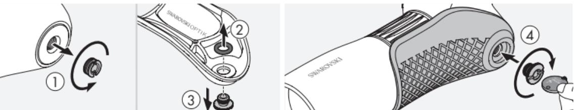
Krok 3: Připevněte poloviční upevňovací prvek ke spodní části teleskopu pomocí pojistného šroubu.
