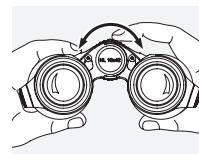
Genom att vrida på fokuseringshjulet kan du fokusera på valfritt objekt från det kortaste fokuseringsavståndet (se det tekniska databladet) till oändligheten.
