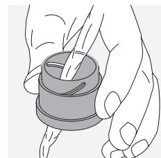
**Suojakotelon puhdistus.** Käytä toimitukseen kuuluvaa saippua-ja harjasarjaa. Sulje okulaari- ja objektiivisuojat. Kostuta harja ja puhdista kotelo varovasti levittämällä saippuaa pyörivin liikkein. Huuhtele kiikarit puhtaalla vedellä ja kuivaa huolellisesti. Jos optiikka kastuu, painele kuivaksi puhtaalla liinalla, jotta optiikka ei naarmuunnu. Huuhtele harja perusteellisesti ja jätä saippua- ja harjasarja kuivumaan.
