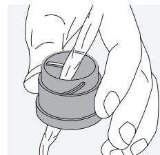
**De behuizing reinigen.** Gebruik hiervoor de meegeleverde zeep en borstelset. Plaats de beschermkappen op de oculairs en objectieven. Maak het borsteltje nat en breng de zeep met ronddraaiende bewegingen aan om de behuizing zachtjes te reinigen. Spoel de verrekijker af met schoon water en droog voorzichtig af. Als het optische systeem nat wordt, dep het dan droog met een schone doek om krassen te voorkomen. Spoel het borsteltje grondig schoon en laat de zeep en borstelset drogen.
