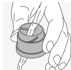
**De behuizing reinigen.** Gebruik hiervoor de meegeleverde zeep en borstelset. Plaats de beschermkappen op de oculairs en objectieven. Maak het borsteltje nat en breng de zeep met ronddraaiende bewegingen aan om de behuizing zachtjes te reinigen. Spoel de verrekijker af met schoon water en droog voorzichtig af. Als het optische systeem nat wordt, dep het dan droog met een schone doek om krassen te voorkomen. Spoel het borsteltje grondig schoon en laat de zeep en borstelset drogen.
