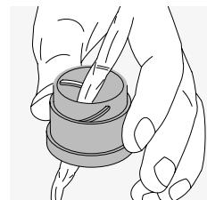
**Suojakotelon puhdistus.** Käytä toimitukseen kuuluvaa saippua- ja harjasarja. Sulje okulaari- ja objektiivisuojat. Kostuta harja ja puhdista koteloa varovasti levittämällä saippuaa pyörivin liikkein. Huuhtele kiikarit puhtaalla vedellä ja kuivaa huolellisesti. Jos optiikka kastuu, painele kuivaksi puhtaalla liinalla, jotta optiikka ei naarmuunnu. Huuhtele harja perusteellisesti ja jätä saippua- ja harjasarja kuivumaan.
