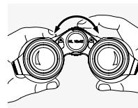
Ved at dreje fokuseringshjulet kan du fokusere på ethvert objekt fra den korteste fokuseringsafstand (se teknisk datablad) til uendelig.
