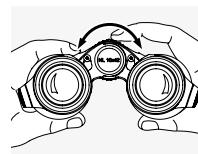
Tournez la molette de focalisation pour effectuer la mise au point sur n'importe quel objet, de la distance minimale de mise au point (voir la fiche technique) à l'infini.
