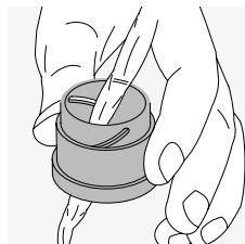
**Очистка корпуса.** Используйте набор из мыла и щетки (входит в комплект поставки). Закройте крышками окуляры и объективы. Смочите щетку, намыльте ее и протрите корпус круговыми движениями для бережной очистки. Промойте бинокль чистой водой и тщательно высушите. Если оптика стала влажной, протрите ее насухо чистой тканью, чтобы не поцарапать. Хорошо промойте щетку и высушите набор из мыла и щетки.
